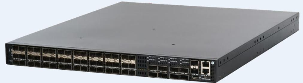
Применяются для создания как транспортного ядра ЛВС ЦОД, так и для подключения вычислительной и сервисной инфраструктуры
